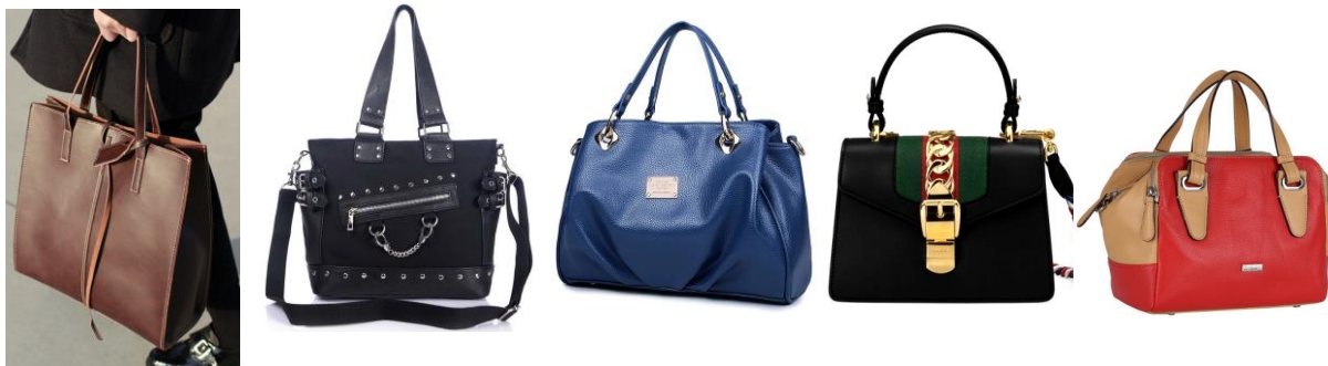
а б в г д Рисунок 3. Способы крепления ручек: а, б – к корпусу сумки на нитки или заклепки; в – в отверстия деталей корпуса; при помощи ручкодержателей: г – готовые (фурнитура), д – изготавливаемые
